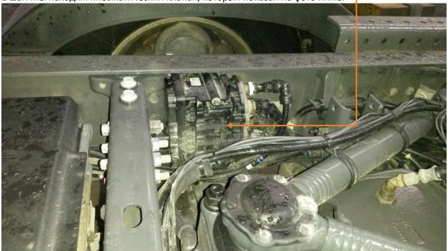
2 шаг. Открутите клапан от рамы, отключите разъем и снимите крышку. Полностью снимать клапана не надо.
