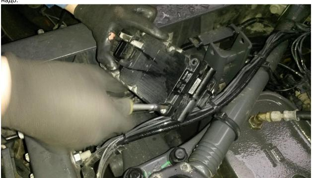
3 шаг. Паям провода на контактах разъема. Снимаем сопротивление, указанное стрелкой и место ее
